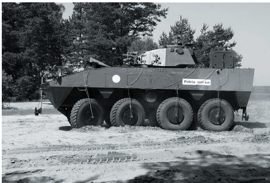
Rys. 5. Pojazd czteroosiowy podczas realizacji skrętu na nawierzchni podatnej Fig. 5. Four-axle vehicle during steering on flexible road surface
