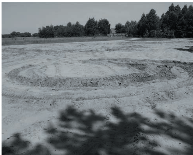
Rys. 8. Ślad po wykonaniu skrętu z wykorzystaniem przyhamowania Fig.8. Trace by vehicle which steering with turn-radius reduction system effectiveness
