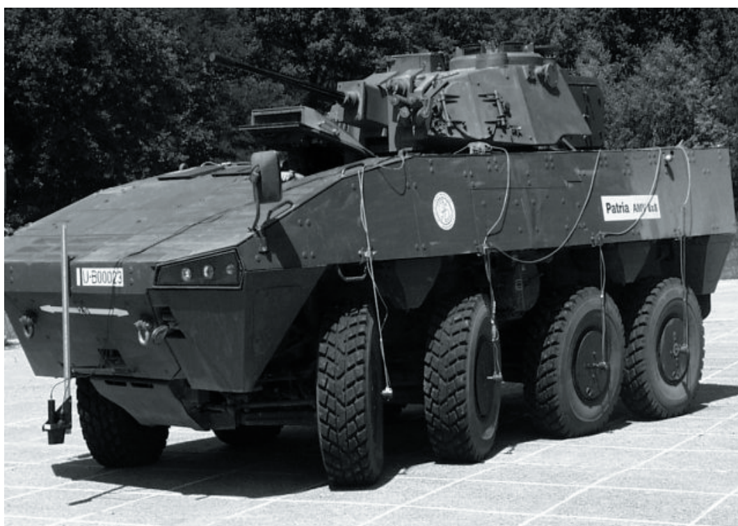
Rys. 3. Pojazd czteroosiowy podczas realizacji skrętu na nawierzchni betonowej
